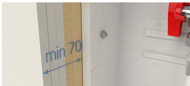
Min 70 mm från utsida gips till framkant skåp.
