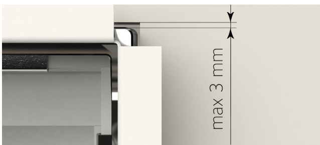
Max 3 mm avstånd mellan kant håltagning och ram.
